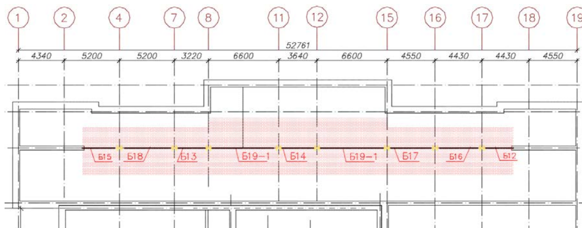
Рис. 2.14. К определению грузовых площадей для балок
